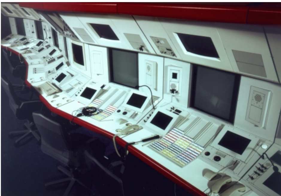
Abbildung 2.3: Fluglotsenarbeitsplätze bei der DFS. Im Vordergrund sind drei Führungsschienen zu sehen, in denen Flugstreifen sortiert werden.
